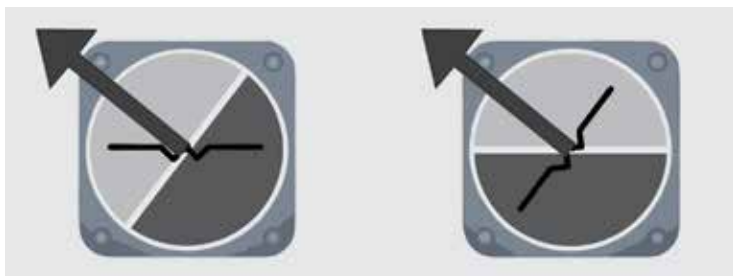
Ryc. 1. Dwa sposoby działania sztucznego horyzontu w maszynach produkowanych w ZSRS i krajach zachodnich. W warunkach ekstremalnego stresu mogło się zdarzyć, że pilot patrzył na urządzenie typu zachodniego, natomiast jego model mentalny powrócił do tego najlepiej oswajonego – sowieckiego. W rezultacie pilot wzmożił odchylenie, zamiast je skompensować.
